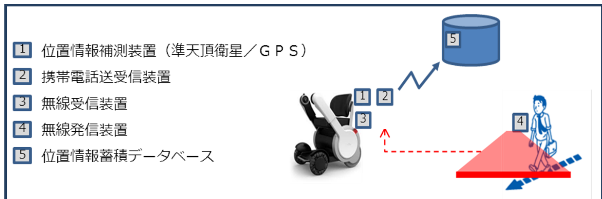
図1) 動態補足技術の概念図
